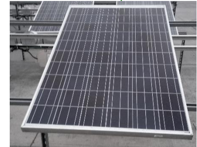
Figura 1. Paneles fotovoltaicos de silicio policristalino
