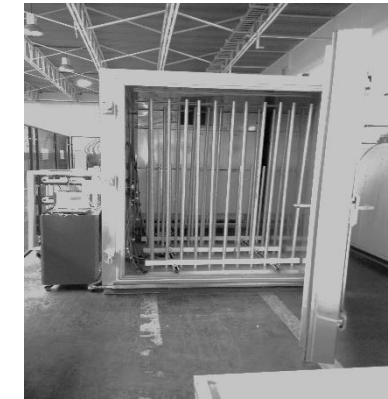
Figura 2. Módulos fotovoltaicos colocados dentro de la cámara climática, en posición vertical
